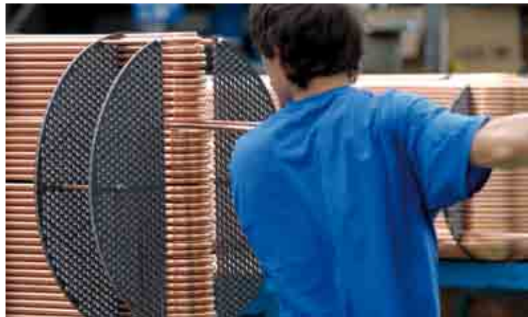
Mounting operation of shell and tube evaporators with increasingly bigger diameters and capacities. Assemblaggio di fasci tubieri con diametri e potenze sempre maggiori.
