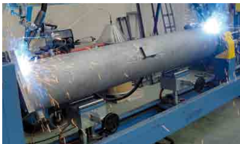
Automatic welding machine / Saldatura automatizzata
